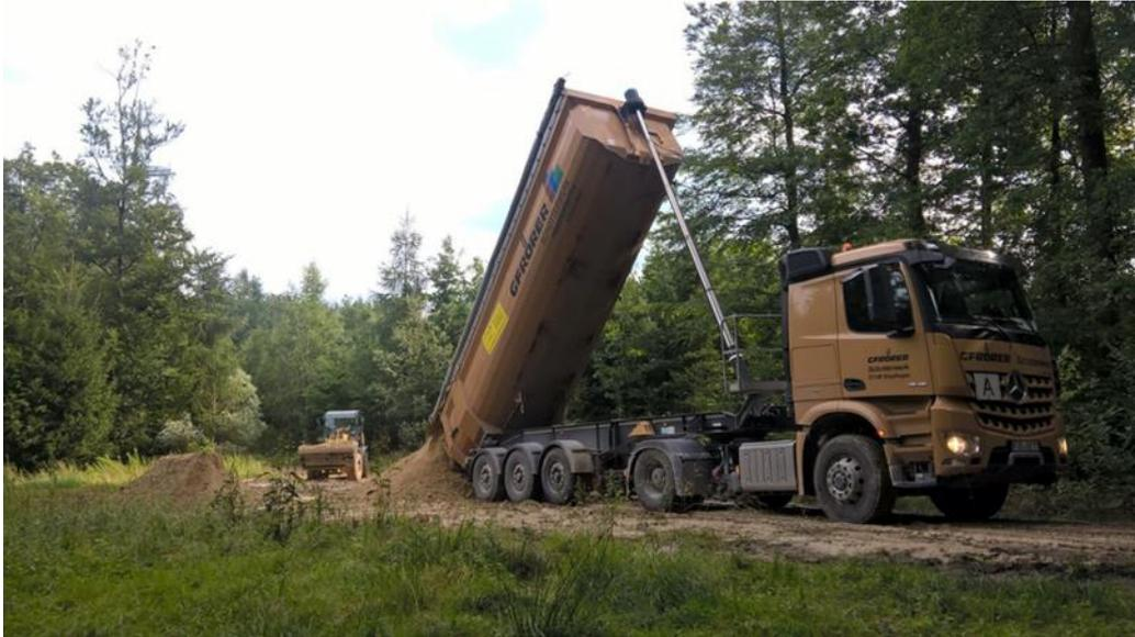
Abb. 1: Ein LKW bringt den gemahlene Kalkstein in den Wald, wo er dann vom Boden oder von der Luft aus weiterverteilt wird (Foto: Forstamt).
